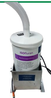
aktive und permanente Überwachung des Aktivkohlefilters mit der "elektronische Schnüffelnase"
